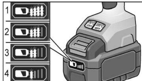
Afișajul se stinge după 5 secunde. Dacă unul dintre LED-uri se aprinde intermitent, acumulatorul trebuie să fie încărcat. Dacă după apăsarea tastei nu se aprinde niciun LED, acumulatorul este defect și trebuie să fie înlocuit.
