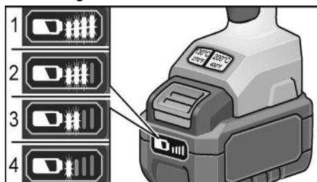
Indikeringen släcknar efter fem sekunder. Om en av lysdioderna blinkar måste batteriet laddas. Om ingen lysdiod lyser när man trycker på knappen är batteriet defekt och måste bytas ut.
