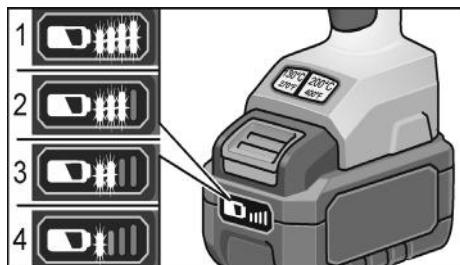
Le voyant s'éteint au bout de 5 secondes. La batterie doit être chargée lorsqu'une LED clignote. Si aucune LED ne s'allume après une pression sur la touche, la batterie est défectueuse et doit être remplacée.
