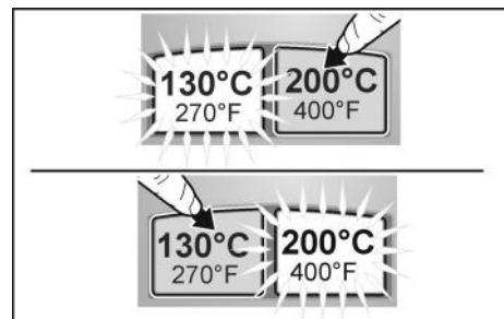
Se puede modificar la temperatura sin problema durante el funcionamiento pulsando la tecla correspondiente.
