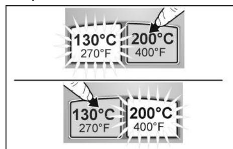
Lämpötilan muutos onnistuu käytön aikana ongelmitta painamalla haluttua painiketta.
